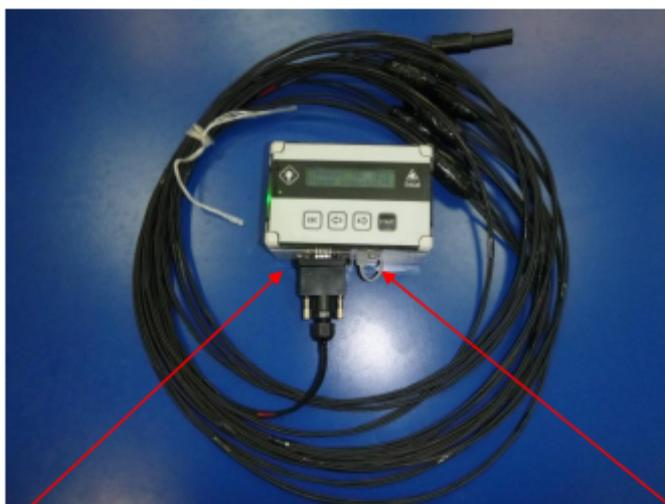
Разъем для подключения термоксы к прибору
